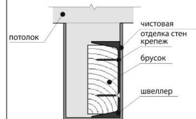
Конструкция внутри проема
