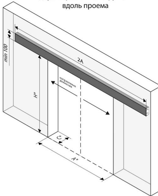
Конструкция внутри проема
